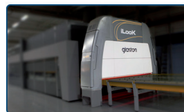
Escaner para el control de calidad GLASTON iLook™
