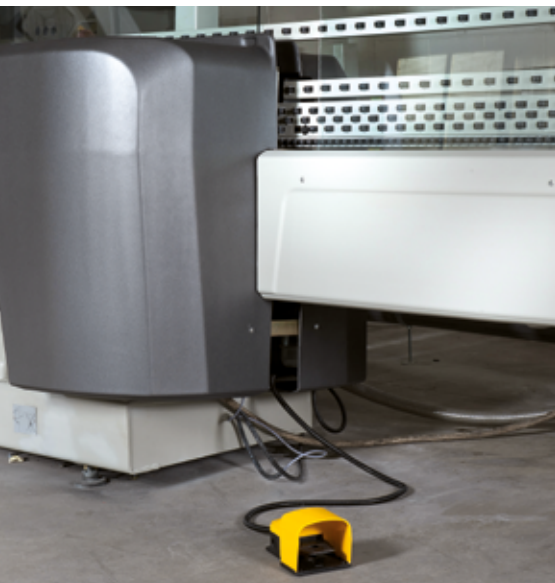
Pedal para activar el brazo de entrada Pedal de acionamento do estágio de emissão da esteira
