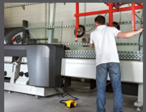
Motorización independiente del transportador de entrada Estágio de emissão da esteira com motorização independente
