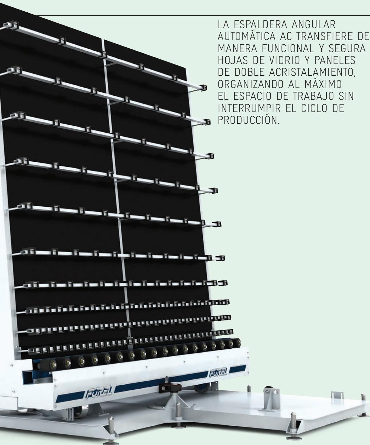
LA ESPALDERA ANGULAR AUTOMÁTICA AC TRANSFIERE DE MANERA FUNCIONAL Y SEGURA HOJAS DE VIDRIO Y PANELES DE DOBLE ACRISTALAMIENTO, ORGANIZANDO AL MÁXIMO EL ESPACIO DE TRABAJO SIN INTERRUPIR EL CICLO DE PRODUCCIÓN.
