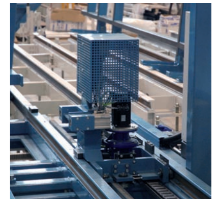
Carro de retirada de elementos
