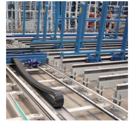
Zona de almacenaje de lanzadera con movimiento longitudinal
