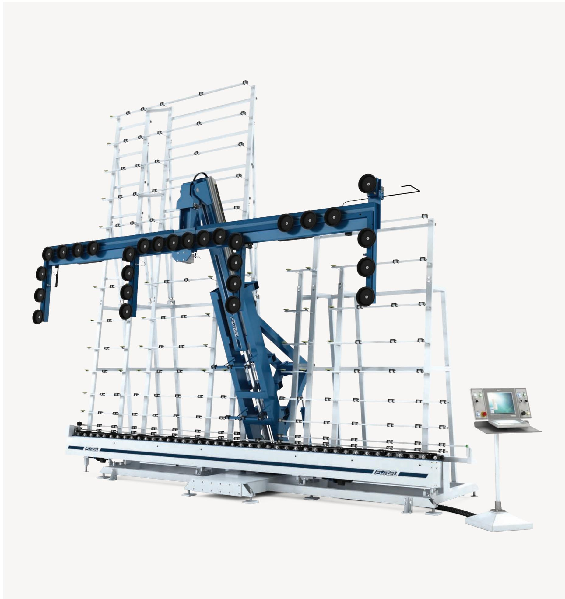
En la fase de retirada la separación de las hojas se lleva a cabo mediante el uso de una ventosa que al moverse por separado crea un espacio intermedio entre las hojas en el que se introduce aire comprimido.
